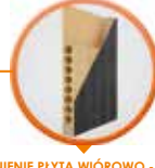
WYPEŁNIENIE PŁYTA WIÓROWO - OTWOROWA. RAMA ZE SKLEJKI I KLEJONKI DREWNA IGLASTEGO Klasa izolacyjności akustycznej Rw=27dB
